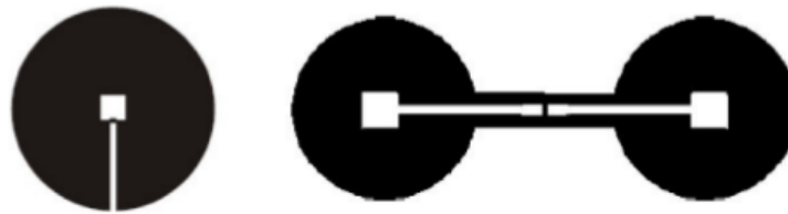
Abbildung 5: Links das Magnetometer – Rechts das Gradiometer, welches an 2 verschiedenen Stellen im Raum das Magnetfeld misst. Entnommen aus [Vorbereitungshilfe].
